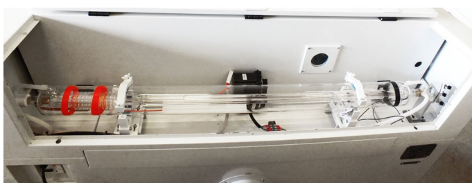
Колба CO2 лазера мощностью 100 Вт.
