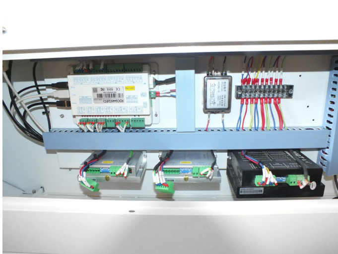
Вся электрическая часть расположена в боковом отсеке станка.
