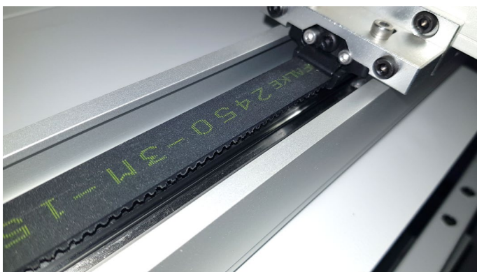
Ременная передача Призматические линейные направляющие.
